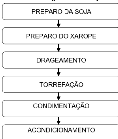
Figura 1 – Etapas do processamento de drageado de soja com cobertura crocante e salgada.
